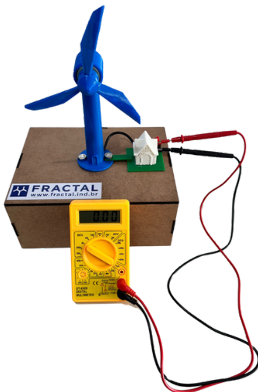
Aparato Montado. Conexão do multímetro com a MiniCasa
